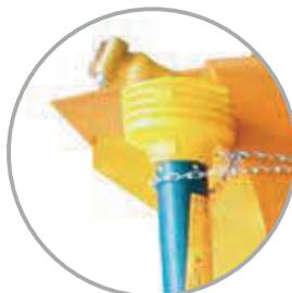
Detalhes: Cardan com proteção
