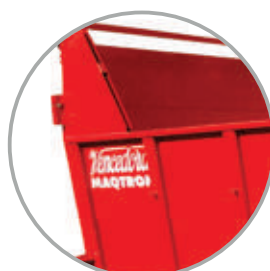
Tampa traseira mais alta para encaixe da sobrecaixa
