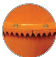
Cremalheira segmentada (detalhe interno)
