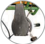
Regulagem de lançamento do produto com comando manual (MQ 800 / MQ 1300)
